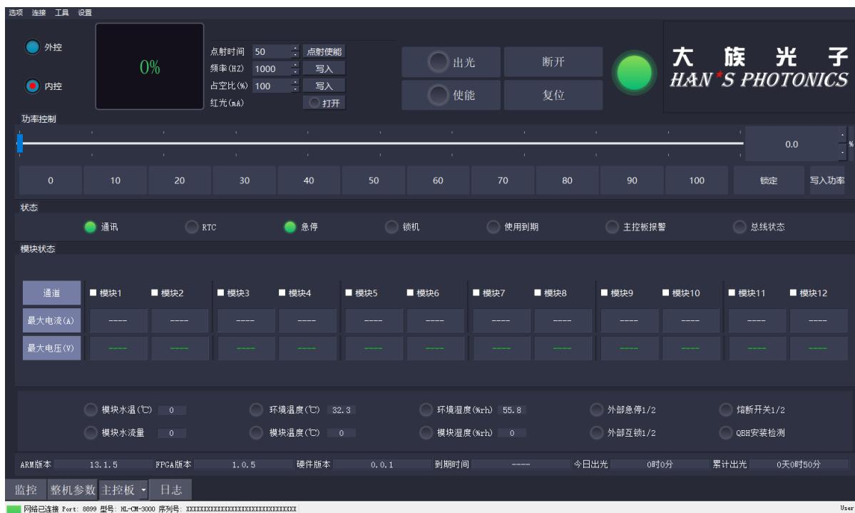
1. 内外控切换：点击内控切换至内控，点击外控切换至外控，如下图属于选中外控状态
