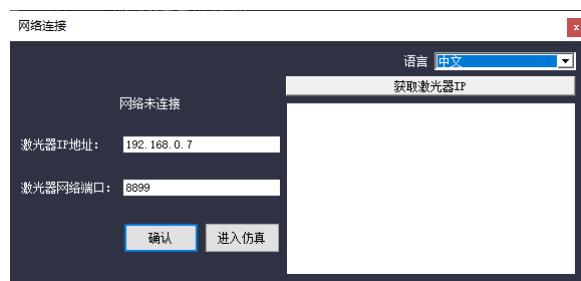
2、对装有操作界面的本地电脑需要进行如下设置：IP地址：192.168.0.xxx（xxx不能设置为激光器的IP地址）；子码掩码：255.255.255.0；默认网关：192.168.0.1
